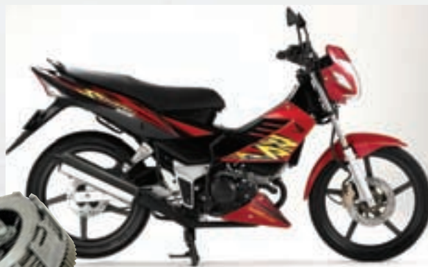
タイ・ホンダの「ノバ・ソニック」に搭載された二輪用多板クラッチ
